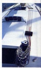
Due winch sulla tuga servono le drizze. Comodo il tambuccio lungo che evita le "capocciate".
