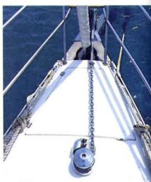
Decisamente da rivedere il sistema di apertu della cala dell'ancora, la catena per raggiungere il salpancora ne impedisce totalmente l'apertura.
