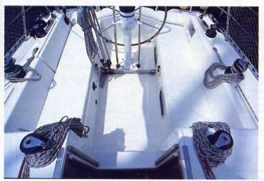
Il pozzetto ha una disposizione classica, enorme il gavone della murata destra di oltre 2 metri cubi di volume. Non ci ha convinto la posizione del trasto randa posto sul fondo del pozzetto anziché sopra le panche. A forti angoli di sbandamento si avverte un indurimento del timone.
