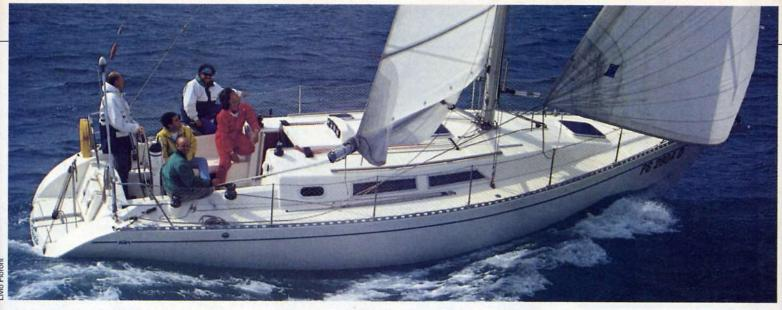
Nella prova che si è svolta con 25 nodi di vento reale e poca onda, abbiamo più volte superato i nove nodi al lasco, pur senza spi. Il dislocamento contenuto e la ridotta superficie bagnata permettono infatti di entrare facilmente in surf, mantenendo una notevole stabilità direzionale. Anche lo spoiler contribuisce alle buone performance che questa barca ha dimostrato di possedere, allungando il galleggiamento di oltre settanta centimetri.
